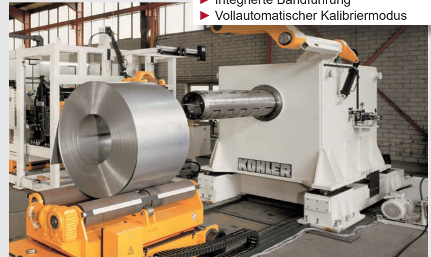
Längsteilanlage (Quelle: Kohler Maschinenbau)
